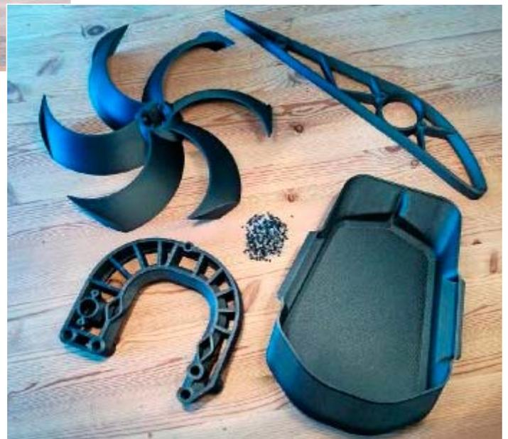
Diese Wanne ist ein weiteres Beispiel für ein großes, belastbares Bauteil. Gedruckt wurde sie aus Polycarbonat mit 14 % Kohlefaser-Anteil. Bild: Starfort
